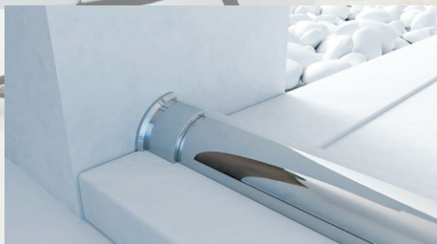
TERMINACIÓN VIERTEAGUAS A PARED.
